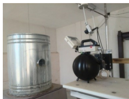
شکل (۴). سیستم پرتو دهی نوترون ۲۴۱ Am-Be موجود در آزمایشگاه SSDL کرج.
