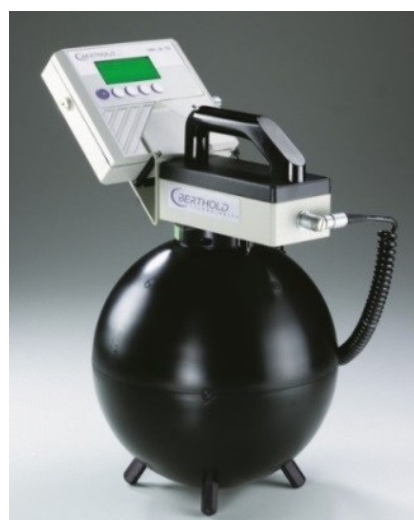
شکل (۵). آشکارساز ۳ He به منظور اندازه گیری آهنگ دز نوترون های چشمه ۲۴۱ Am-Be.
