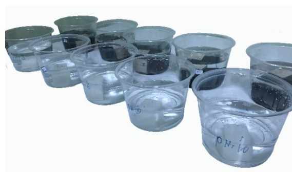
شکل (۳): نمونه‌های سنگی نگهداری شده تحت pHهای مختلف.
