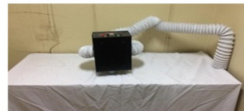
شکل (۶): مراحل ساخت هوزینگ تیوب مولد ایکس جهت حذف سرب کوبی اتاق اشعه ایکس [۲۱].
