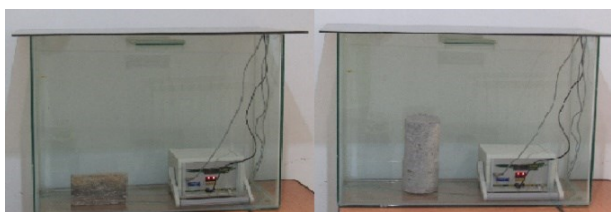
شکل (۳): محفظه اندازه‌گیری، دستگاه RTM1689 و نمونه‌های درون محفظه بسته جهت اندازه‌گیری غلظت رادون.
