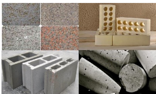
شکل (۲): مصالح ساختمانی انتخاب شده: بلوک‌های بتنی، نمونه استوانه‌های بتنی، آجر سفال و سنگ‌های گرانیتی.
