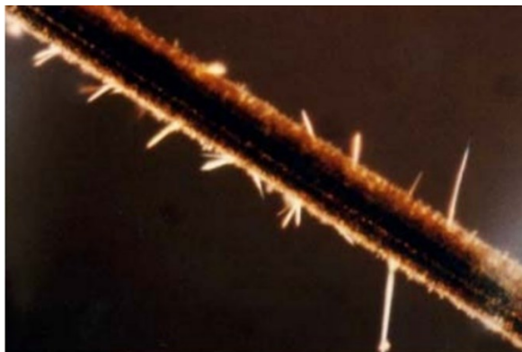
شکل (۱): بلورها و رشته‌های سوزنی روی آند [۱۱].
