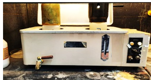
شکل (۳). حمام آبی و بطری‌های حامل اسید ۴۸٪ HF جهت خورش شیمیایی نمونه‌های میکا.
