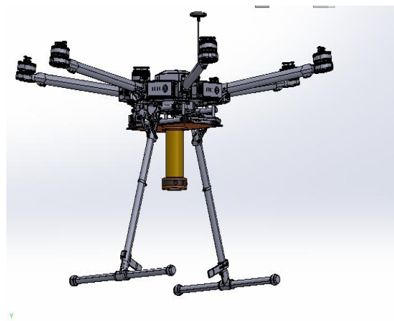
شکل (۶). مدل سازه مونتاژ شده بعد از نصب بر روی ربات پهپاد.
