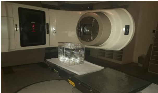
شکل (۱): نمای از طرز قرارگیری نمونه‌ها در فانتوم آب و سیستم شتاب‌دهنده خطی واریان.
