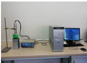
شکل (۴): نحوه اندازه‌گیری رادن با CsI(Tl) . ظرف آب جلوی آشکارساز CsI(Tl) قرار گرفته است.
