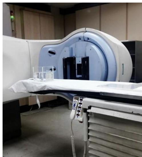
شکل (۳): تنظیمات تجربی فانتوم حاوی آب و نترات گادولینیوم و دستگاه شتاب‌دهنده خطی الکترون بیمارستان میلاد اصفهان.
