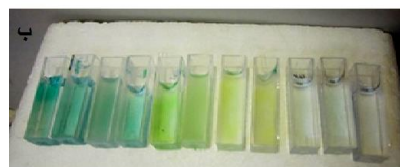
شکل (۴): الف) فانتوم طراحی شده از جنس پلکسی‌گلس، ب) نمونه دزیمترهای تابش‌دهی شده با سطوح مختلف دز.
