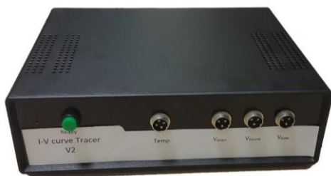
شکل (۴): نمای ظاهری دستگاه رسم‌کننده منحنی جریان-ولتاژ ساخته‌شده به‌همراه جعبه مدار واسط برای اتصال و خوانش قطعات ماسفت.
