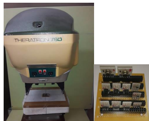
شکل (۵): سیستم پرتو دهی آزمایشگاه SSDL کرج و برد قرار گیری قطعات ماسفت.
