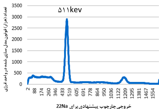
شکل (۹): خروجی چارچوب پیشنهادی برای ^{22}\text{Na} با اکتیویته 1/16 میکروکوری در مقایسه با داده واقعی.
