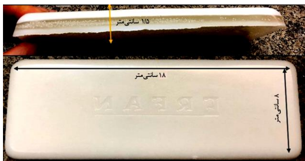
شکل (۳): شمایی از شکل و ابعاد حفاظ کامپوزیتی ساخته شده شامل ۸۹٪ پلی متیل متاکریلات، ۵٪ پلی اتیلن چگالی بالا و ۶٪ اسیدبوریک.
