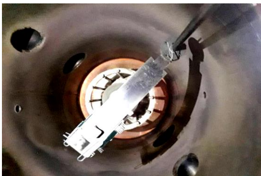
شکل (۱): شماتیک ساختار دستگاه پلاسمای کانونی MTPF-2 و چیدمان قرارگیری نمونه‌ها داخل دستگاه به صورت عمود بر محور الکترودها.
