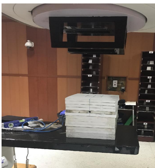
شکل (۳): تصویری از چیدمان آزمایش جهت اندازه‌گیری بار در فانتوم معادل ریه.
