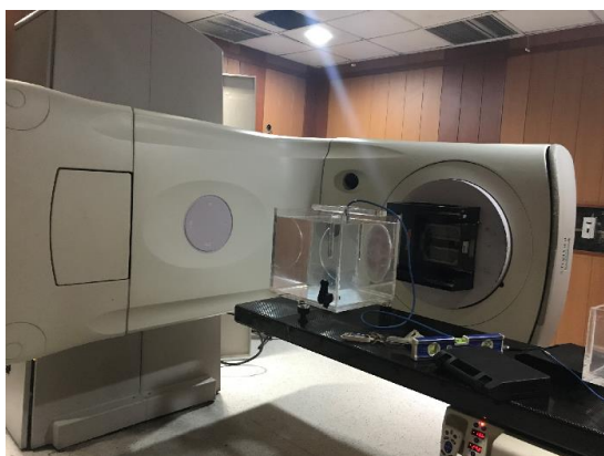
شکل (۲): تصویری از چیدمان آزمایش جهت اندازه‌گیری بار در فانتوم آب.
