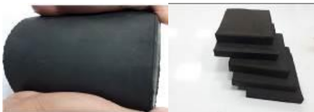
شکل (۶): نمای از حفاظ انعطاف‌پذیر ساخته شده.
