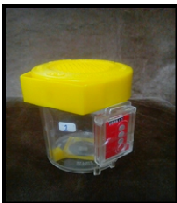
شکل (۳): اتاقک نفوذی رادون به همراه دزیمتر ترمولومینسانس جهت اندازه‌گیری دز گامای داخل منازل.
