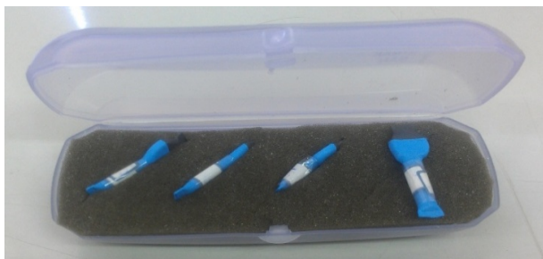
شکل (۳): چشمه‌های سنج‌بندی ^{60}\text{Co} و ^{65}\text{Zn} ساخته شده.
