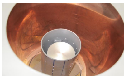
شکل (۲): چیدمان آزمایشگاهی برای تعیین بازده شمارش چشمه
