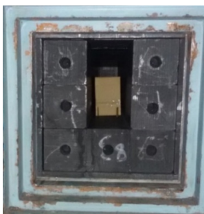
شکل (۶): بارگذاری فویل‌های ایندیم در محل قرارگیری آشکارساز در ستون حرارتی رآکتور تحقیقاتی تهران
