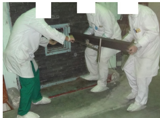
شکل (۵): بارگذاری آشکارساز ترموپیلی در ابتدای ستون حرارتی
