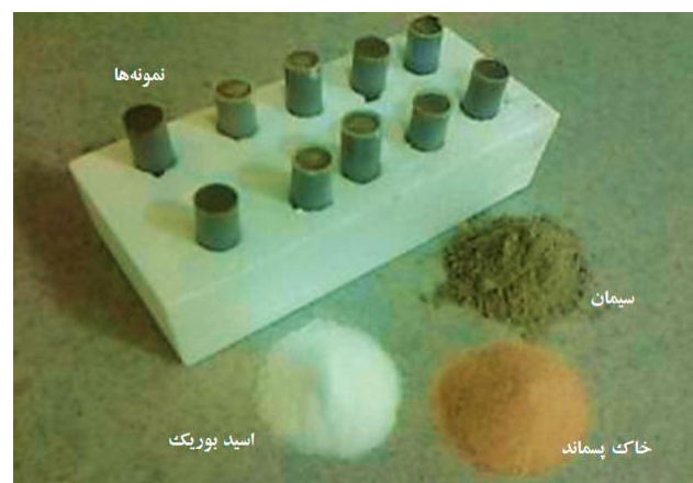
شکل (۱): اسید بوریک، خاک پسماند، سیمان و نمونه‌های آماده شده برای پرتودهی
