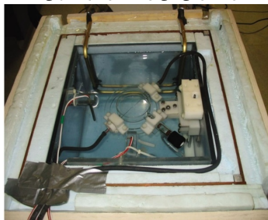
شکل ۲: نمایی از یک کالریمتر آب نوعی بدون لایه بالایی [۵]
