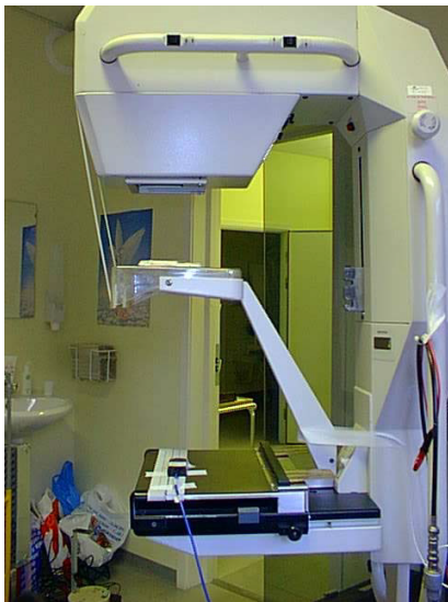
شکل ۳: محل قرارگیری دزیمتر در اندازه‌گیری لایه نیم‌کننده
