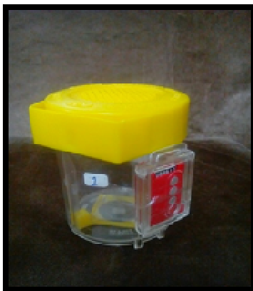
شکل (۳): اتاقت نفوذی رادون به همراه دزیمتر ترمولومینسانس جهت اندازه‌گیری دز گامای داخل منازل.
