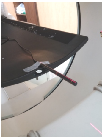
شکل (۴): نحوه قرارگیری اتاقک یونیزاسیون برای اندازه‌گیری مقدار شاخص دز سی تی در هوا.
