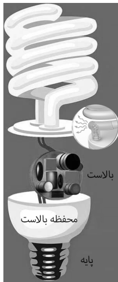
شکل (۱): اجزای لامپ فلورسنت فشرده.
