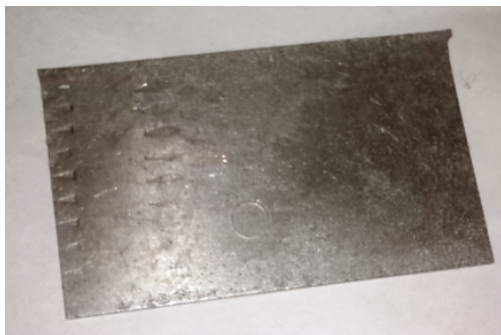
شکل ۱: فانتوم لبه ساخته شده که برای به‌دست آوردن تصویر لبه از آن استفاده شده است.
