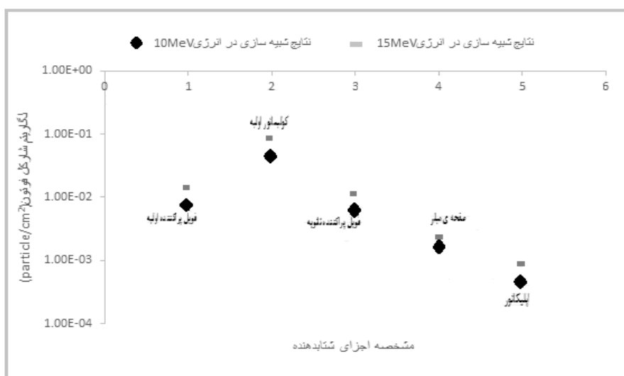
شکل ۸: نمودار مقایسه مجموع شار فوتون ترمزی تولید شده ناشی از برهم‌کنش الکترون در هریک از اجزای در انرژی‌های 10\text{MeV} و 15\text{MeV}
